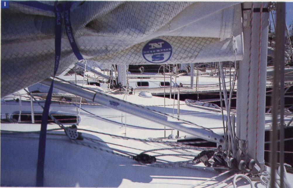
**Foto 1** - Il piede d'albero. In primo piano i bozzelli di rinvio delle drizze, dell'amantiglio del tangone, delle borose e del tesabase.
